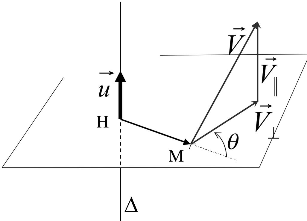
Figure 2.3. Analyse de la signification explicite du moment cinétique par rapport à un axe.
