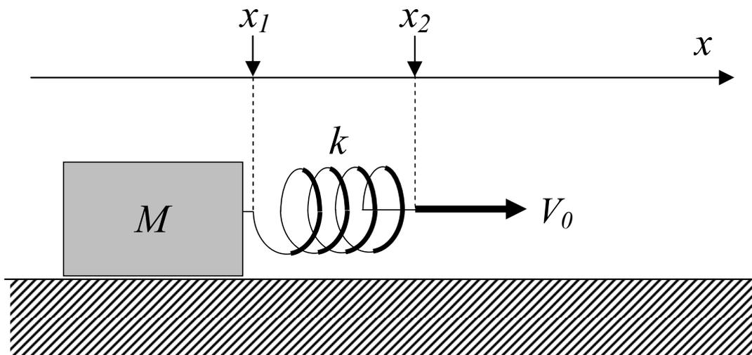
1.1 ) A l'instant  $t=0$ , le patin est immobile et on a  $x_1=0$  et  $x_2=L$ . Que se passe-t-il quand, à  $t=0$ , on commence à tirer le ressort? Jusqu'à quel moment  $t_0$  cette situation perdure? Quelle est l'expression de  $x_1$  et  $x_2$  quand  $t=t_0$ ? On notera  $f_s$  le coefficient de friction statique entre le patin et le plan.
