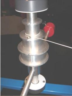
Dans ce projet, on étudiera le comportement physique d'une machine d'Atwood particulière. Comment transformer un mouvement rectiligne uniformément accéléré en mouvement de rotation uniformément accéléré ? On en profitera pour revoir les équations du mouvement rectiligne uniformément accéléré et on déduira les équations du mouvement de rotation uniformément accéléré. Quelles prédictions pouvez-vous tester avec le dispositif disponible?
