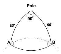
Calculer  $\Delta$  la longueur de la géodésique entre A et B. Calculer  $\delta$  la distance sur le cercle parallèle entre A et B.
