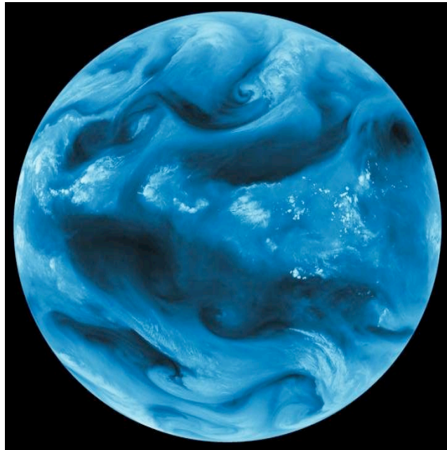
Image Météosat de la Terre dans le canal 5,7-7,1 \mu\text{m} (zone d'opacité de \text{H}_2\text{O} )
