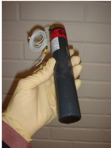
**Fig. 2** : Electrode de mesure du potentiel spontané.
