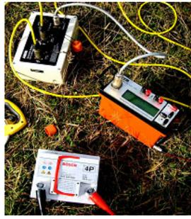
FIG. 2 – Le résistivimètre ABEM, la centrale d’acquisition et la batterie.
