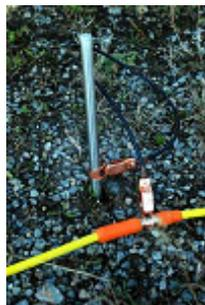
FIG. 1 – Un câble noir qui relie une électrode à une prise
