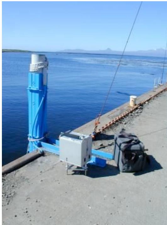
Capteur de pression en fond de mer et système de communication
